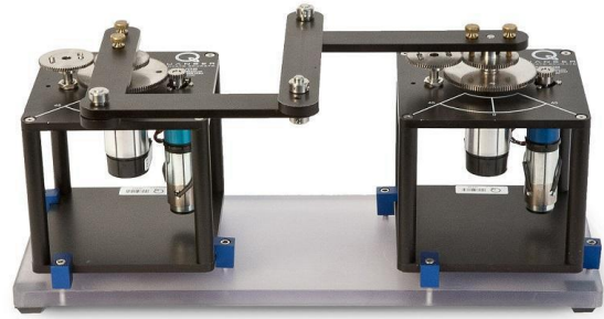
Fig. 2.2 Quanser- 2 DoF Robot
